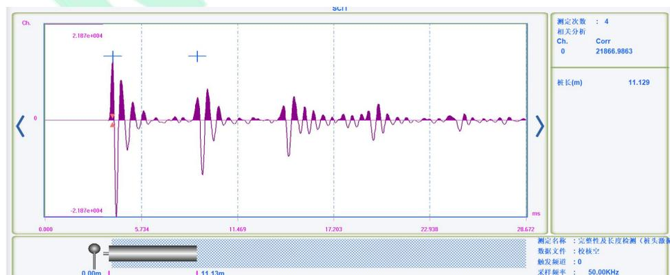
图 2-7-7 波速标定典型波形图 (空置管桩)
