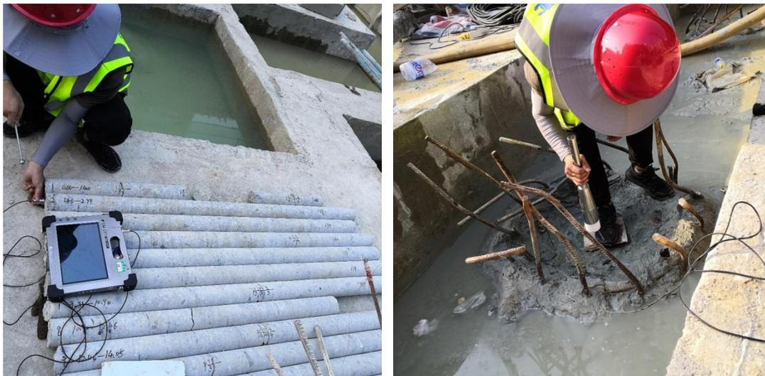
图 2-6-5 波速标定及现场检测场景
