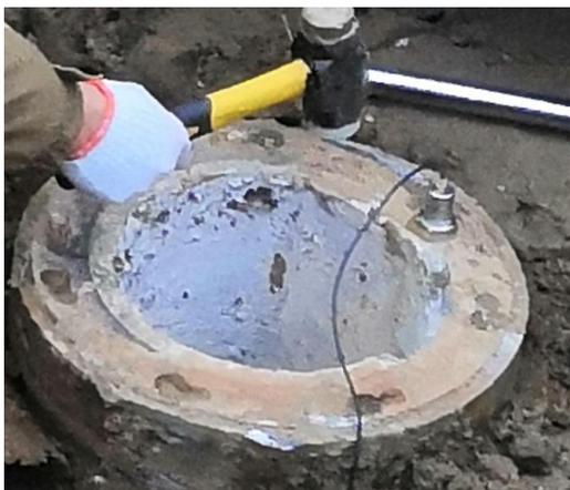
图 2-7-5 管桩现场检测示意图
