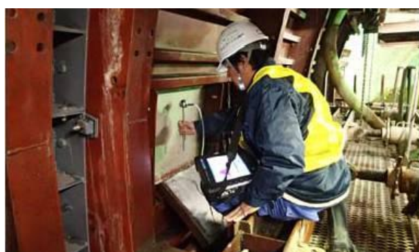
照片 5-2-1 隧道衬砌混凝土检测 图 5-2-2 不同龄期混凝土打球测试结果对比
