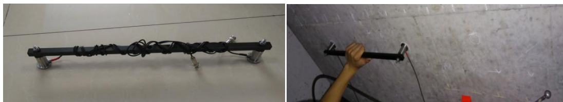
图 4-2-9 混凝土强度测试支架及使用情形
