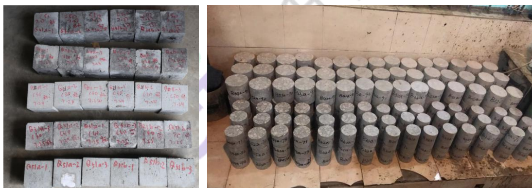
照片 4-3- 5 左：试块（10cm，30 个），右：芯样（ \Phi 70 、 \Phi 100 ，径高 1:1，共 254 个）
