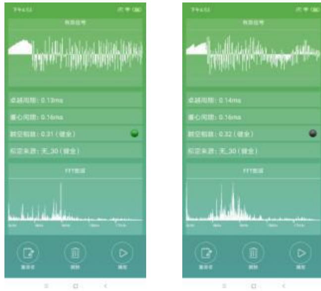
图 2-3-7 测点 1 (缺陷) 数据 测点 4 (健全) 数据
