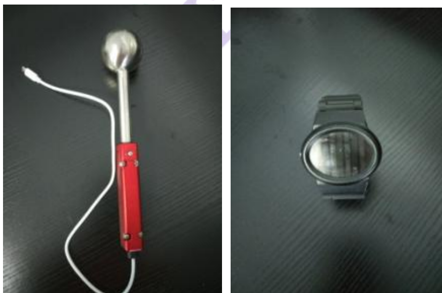
图 1- 2-2 连续采集用激振锤及信号传送用蓝牙手表
