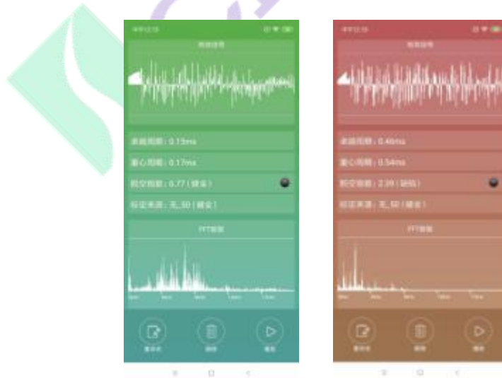
图 2-3-7 测点 4 (健全) 测点 1 (缺陷) (注意手机画面颜色变化)
