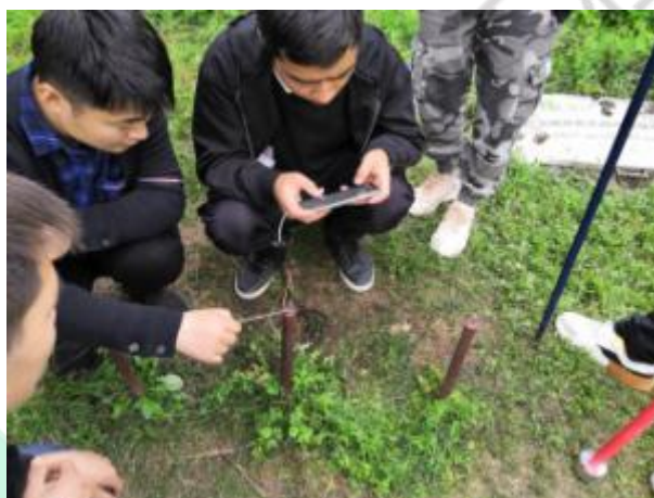
图 6-2-1 手机锚杆长度试验
