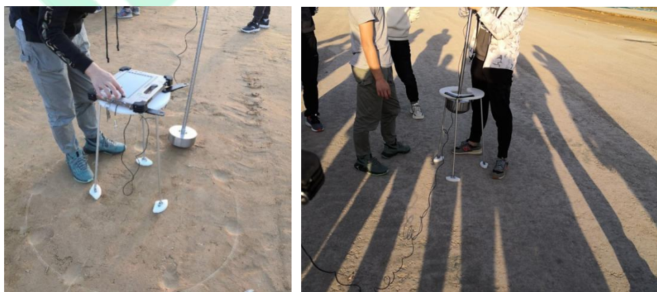
图 2-7-23 现场测试场景（左侧为粘土材料、右侧为水稳材料）
