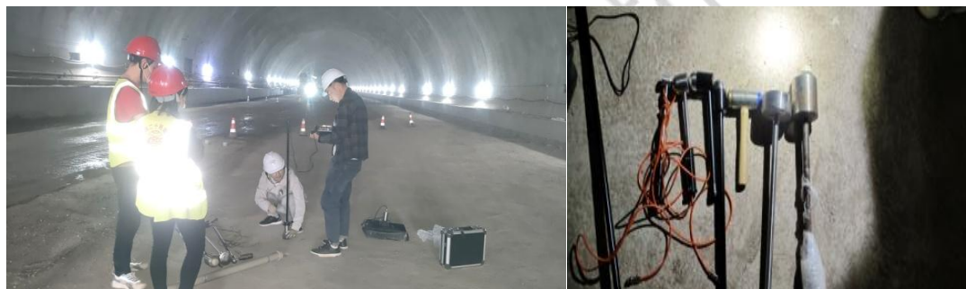
检测情景及所用激振装置
