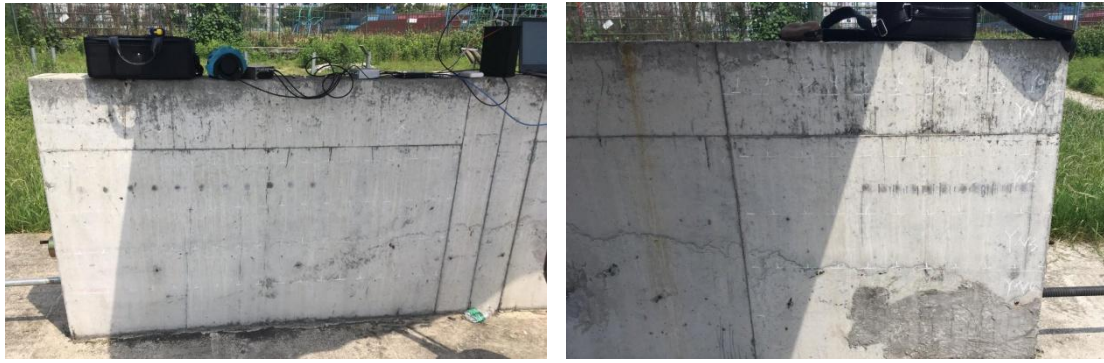
图 2-3-9 现场测试布置图(左: 20cm, 右: 40cm 厚灌浆段)
