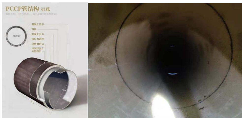
图 2-5-1 PCCP 管结构示意图
