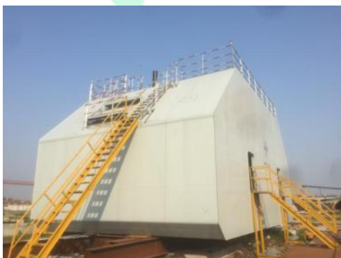
钢管混凝土沉管检测模型
