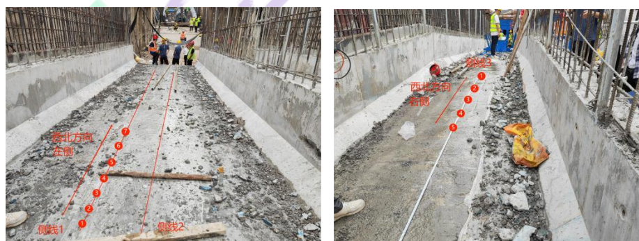
测线布置示意图（左：两条测线；右：一条侧线）
