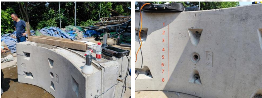
测试模型以及测点测线示例图
