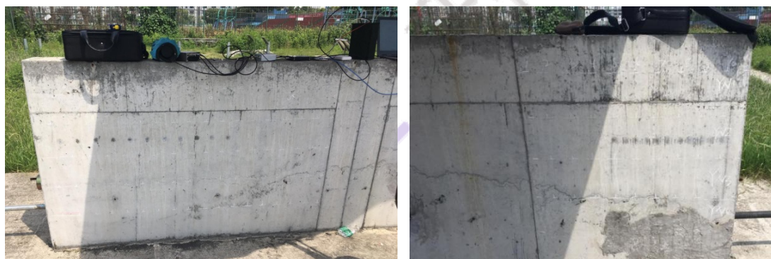
现场测试布置图(左：20cm，右：40cm 厚灌浆段)
