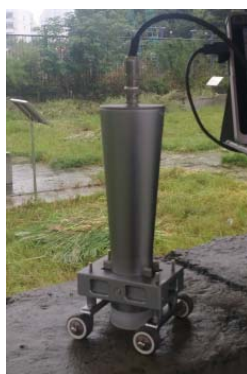
混凝土冲击回波仪 (I 型原型)
