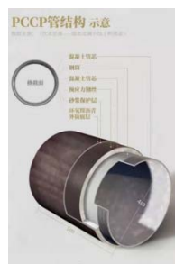
PCCP 管结构示意图
