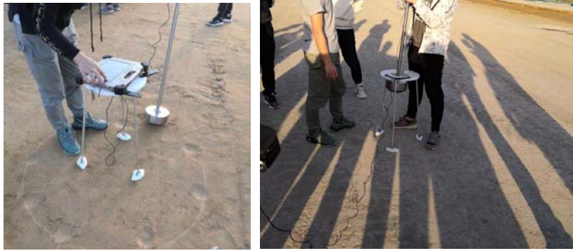
现场测试场景（左侧为粘土材料、右侧为水稳材料）
