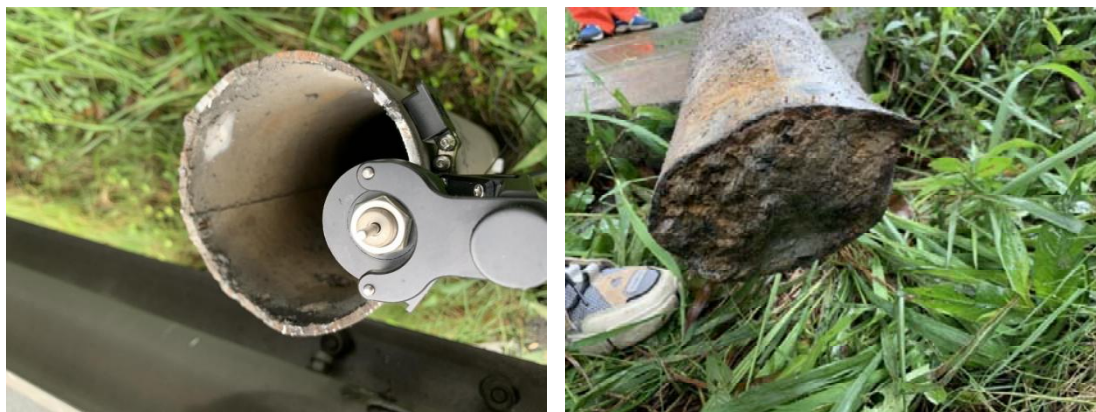
图 2-4-22 左：端头切割痕迹，右：桩底打卷状况
