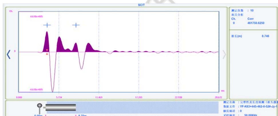
管桩长度异常的检测结果图
